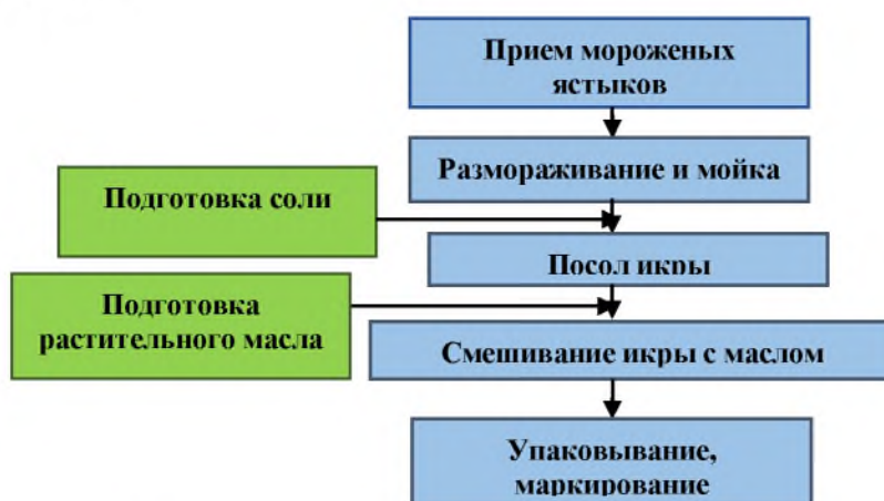
Рисунок 3.2 – Технологическая схема производства икры сельди соленой ястычной
