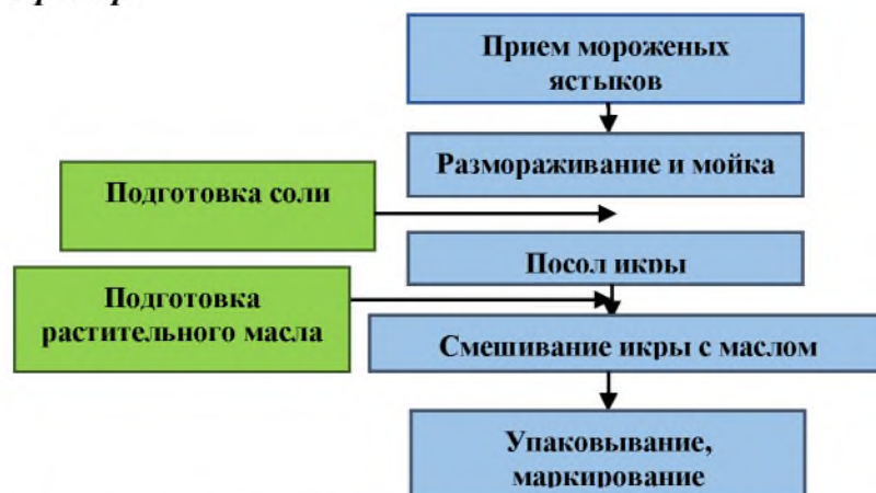
Рисунок 3.2 – Технологическая схема производства икры сельди соленой ястычной
