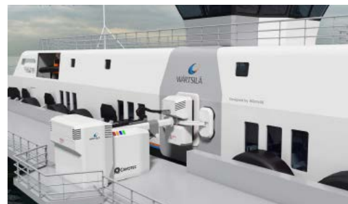
Рис. 6. Технология с беспроводной индукционной зарядкой
