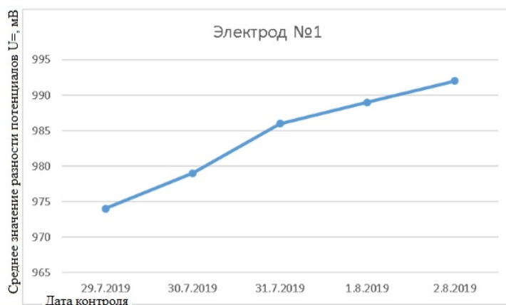
Рис. 2. Динамика результатов измерений разности потенциалов между корпусом судна ПЖС-219 и электродом № 1
