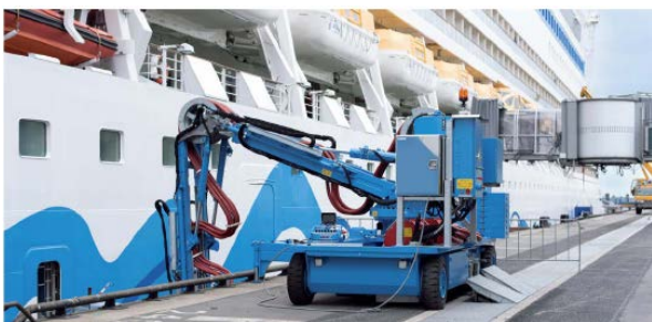
Рис. 5. Традиционное кабельное подключение
