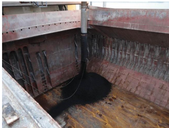
Рис. 3. Последствия возгорания древесины в трюме
