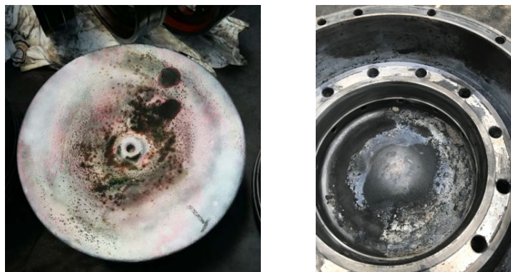
Рис. 1. Выгорание днища поршня из-за неправильного распыла форсунок
