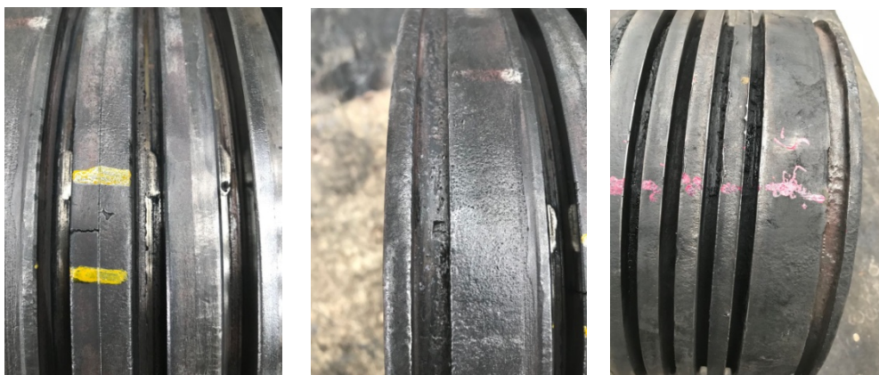
Рис. 2. Износ канавок компрессионных и маслосъемных колец
