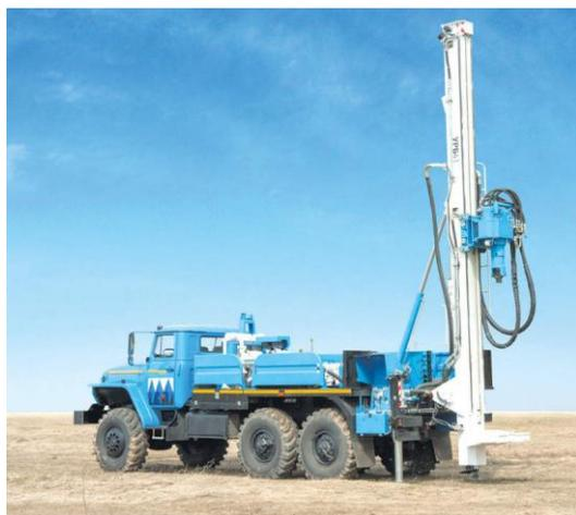
Рис. 4. Оборудование роторного бурения
