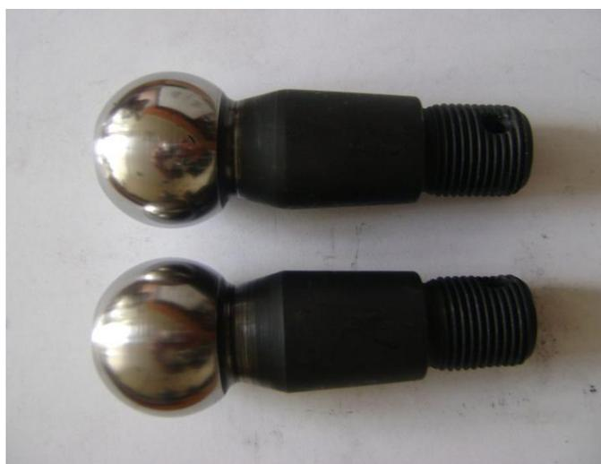
Рис. 2. Шаровые пальцы с полированной исполнительной сферической поверхностью
