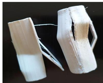
Рис. 2. Характер разрушения модели из ABS-пластика при горизонтальной печати
