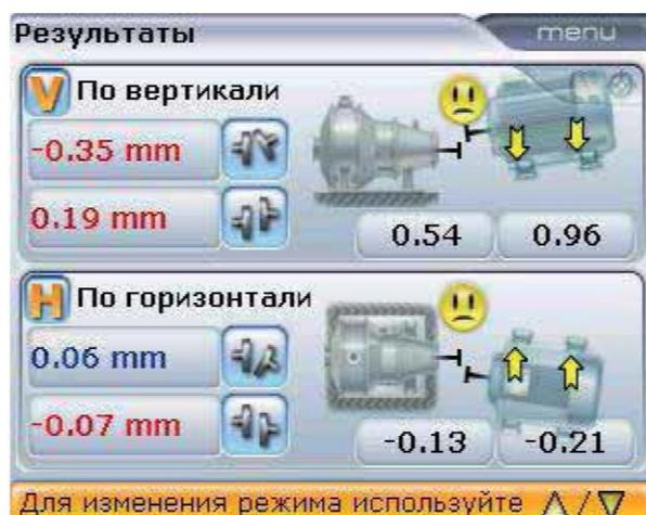
Рис. 3. Результаты предварительного измерения относительного расположения агрегатов на мониторе компьютера OPTALIGN Smart
