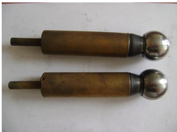
Рис. 4. Заготовка в оправке
