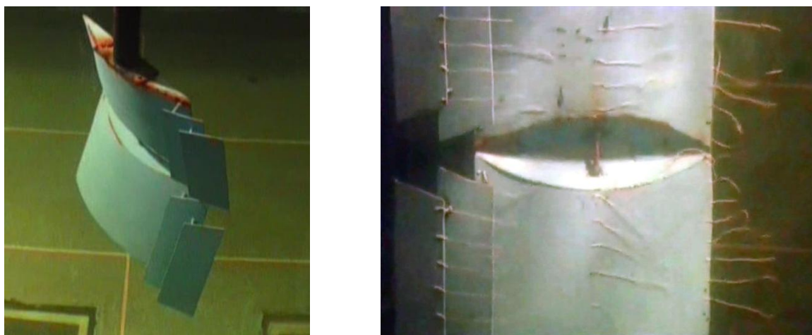
Рис. 4. Модель распорной траловой доски в гидроканале ЗАО «МариНПО»
