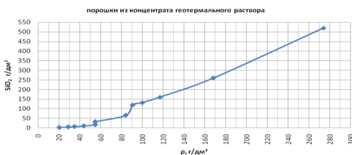
Рис. 9. Зависимость насыпной плотности нанопорошка от содержания SiO 2
