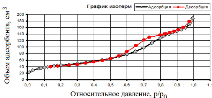
Рис. 8. Кривые сорбции – десорбции для порошка УФ – 44, полученные методом низкотемпературной адсорбции жидкого азота, p_0 – давление насыщенного азота
