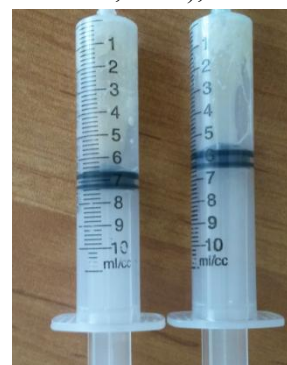
Рис. 2. Увеличение высоты подъёма поршня в результате выделения диоксида углерода
