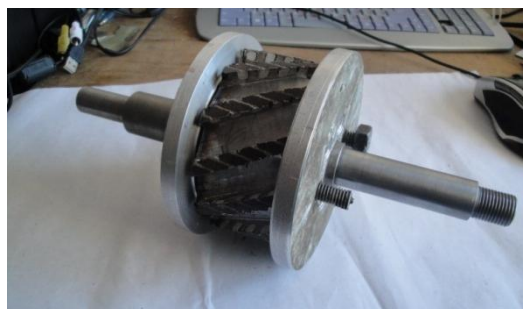
Рис. 2. Внешний вид ротора генератора предлагаемой электростанции
