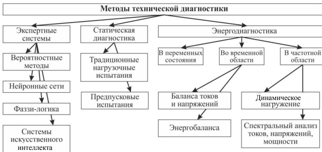
Рис. 2. Структура методов диагностики технического состояния электрических машин
