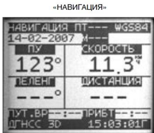
Рис. 8. Отображение основной навигационной информации (курс, скорость, пеленг, дистанция) при движении судна по заданному маршруту
