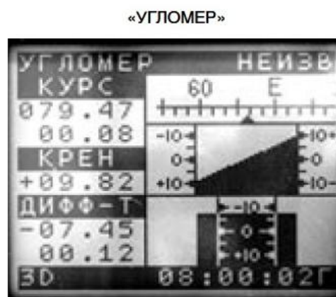
Рис. 9. Цифровое и аналоговое отображение углов пространственной ориентации судна: углов курса, крена и дифференциала с оценкой точности выработки вертикальных и горизонтальных углов
