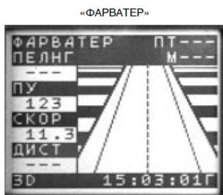
Рис. 6. Отображение навигационной информации и графическое представление отклонения от заданного направления при движении судна по маршруту. Отклонение индицируется в графическом и цифровом виде
