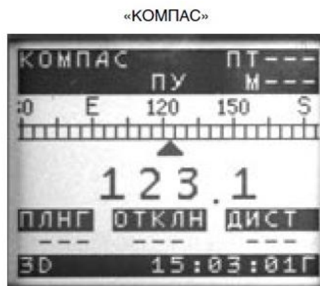
Рис. 7. Графическое отображение аналоговой шкалы путевого угла, а также дополнительной навигационной информации при движении по маршруту (пеленг, дистанция, отклонение от заданного направления)
