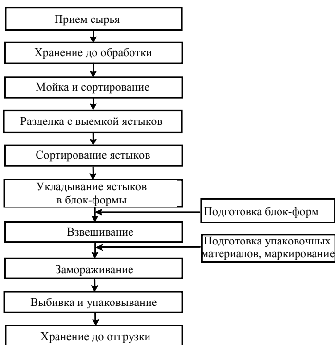
Рис. 2. Технологическая схема производства мороженной ястычной икры минтая
