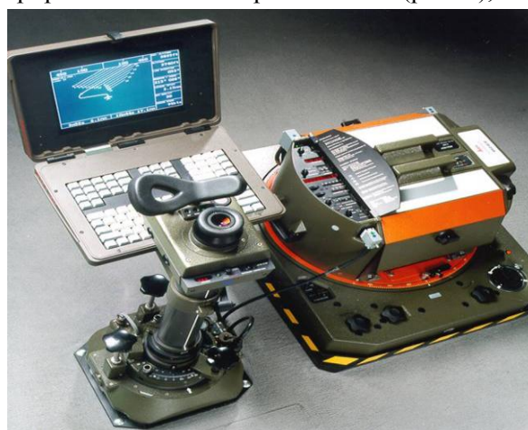
Рис. 3. Аэрофотокомплекс, интегрированный с GPS-приемником
