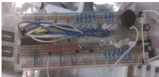
Рис. 1. Бинарные часы с календарем и будильником
