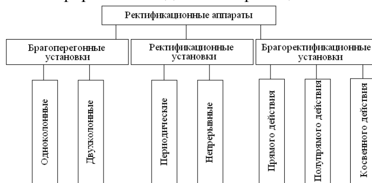
Рис. 1. Классификация ректификационных аппаратов
