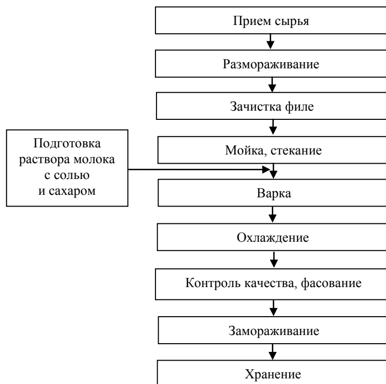
Рис. 1. Технологическая схема приготовления замороженной салатной добавки на основе мышечной ткани минтая
