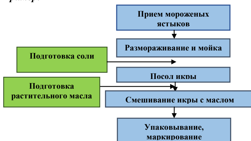
Рисунок 3.2 – Технологическая схема производства икры сельди соленой ястычной
