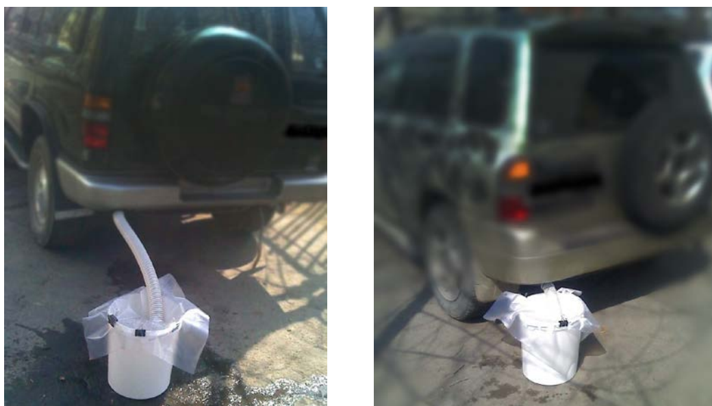
Рисунок 2 – Устройство для замеров взвесей выхлопа автомобиля, состоящее из пластикового ведра, шланга и целлофана с зажимами для фиксации: а – дизельный двигатель, б – бензиновый двигатель
