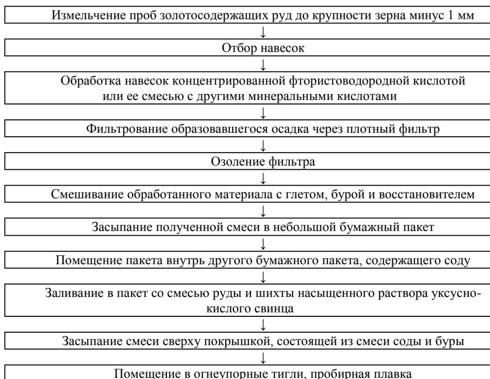
Рис. 2. Алгоритм операций подготовки навесок золотосодержащих руд к пробирной плавке (вариант 2)
