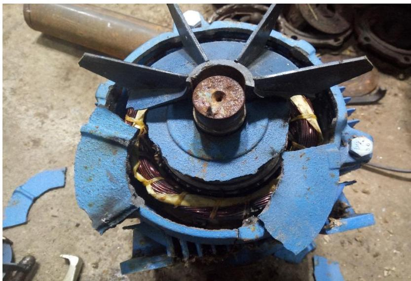
Рис. 1. Разрушение подшипникового щита электропривода из-за повышенной вибрации
