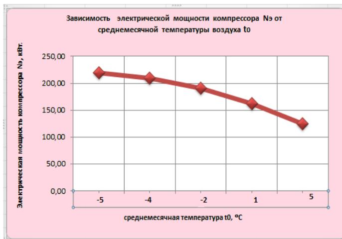
Рис. 4. Зависимость электрической мощности компрессора от среднемесячной температуры
