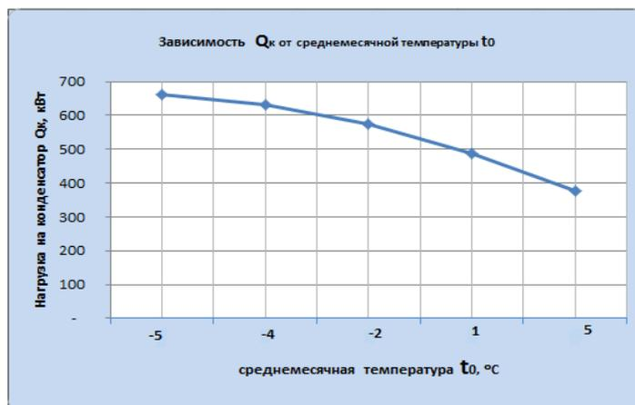
Рис. 3. Зависимость нагрузки на конденсатор от среднемесячной температуры воздуха
