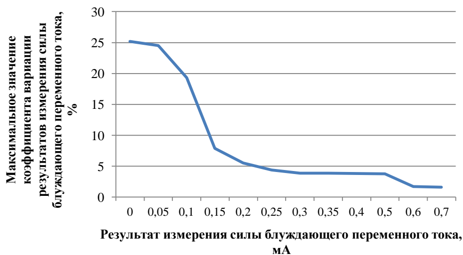
Зависимость максимального значения коэффициента вариации результатов измерения силы блуждающего тока I , мА от ее среднего значения
