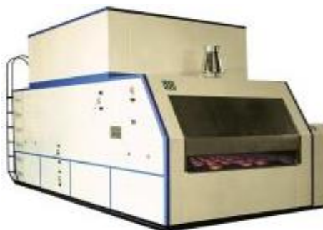
Рис. 1. Тупиковая хлебпекарная печь
