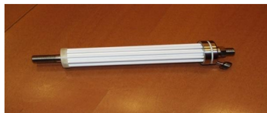
Рис. 3. Внешний вид нанофильтрационной мембраны CSM NE 4040-70, применявшийся при экспериментах по очистке природных вод от цветности и мутности, концентрированию молочных продуктов (фото авторов)
