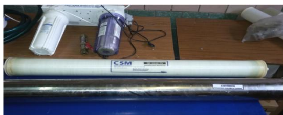
Рис. 2. Внешний вид керамического мембранного фильтра, применявшийся при экспериментах по концентрированию молочных продуктов (фото авторов)
